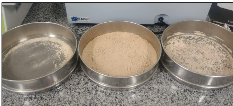
Figura 1: Conjuntos de peneiras da série Tyler utilizadas Fonte: Autores (2019)
