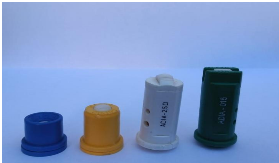
Figura 1. Pontas de pulverização utilizadas na realização do experimento. Respectivamente: Cone vazio Mag 1, Cone CH 100, Jato plano duplo antideriva AD-IA 025.D e Jato plano antideriva AD-IA 015 110.
