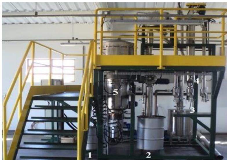
Figura 1. Foto frontal do gaseificador. (1) tambor de cinzas pesadas (2) tambor de cinzas leves (3) saída do alcatrão (4) saída para coleta de *syngas* (5) gaseificador de leito fluidizado
